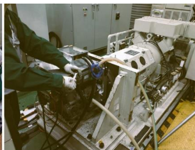
【性能試験】1軸ダイナモ試験機(試験前確認)
