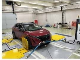
【車両試験】 シャシーダイナモ試験機
